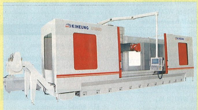
Als Weltneuheit ist die Bettfräsmaschine KNC U 1350 von Kiheung mit einem Verfahrensweg der Y-Achse von 1350 mm zu bestaunen.
